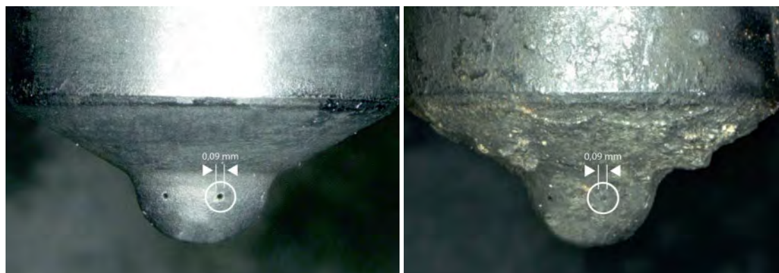
Op deze foto's is goed te zien dat de piepkleine gaatjes in de injectoren helemaal dichtslibben door de verontreiniging in de snel verouderende benzine.
