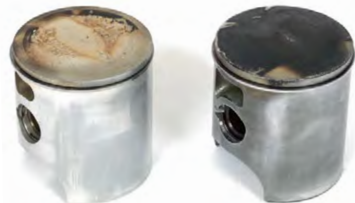
Een goede benzine levert een mooie schone verbranding op, en daarmee een hoog rendement van de motor.
