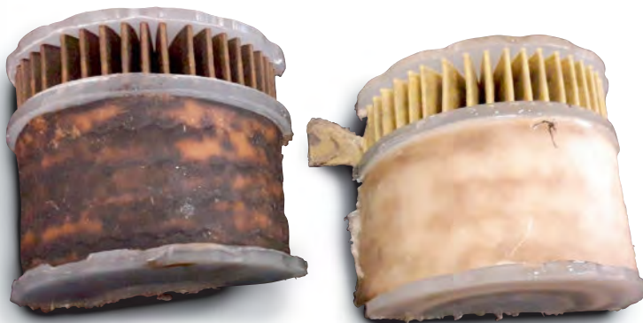
Een gebruikt, opgezaagd benzinefilter vergeleken met een nieuw benzinefilter.
